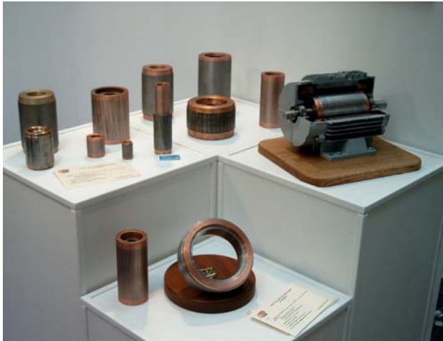
Figura 1: Rotores en jaula de ardilla hechos en cobre fueron exhibidos al público por primera vez en la Hanover Trade Fair en 2003
