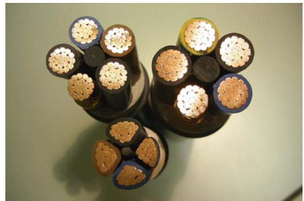
Figura 6: Solo en cables de baja tensión para altas intensidades el cable ocupa la mayor parte de la sección total transversal.
