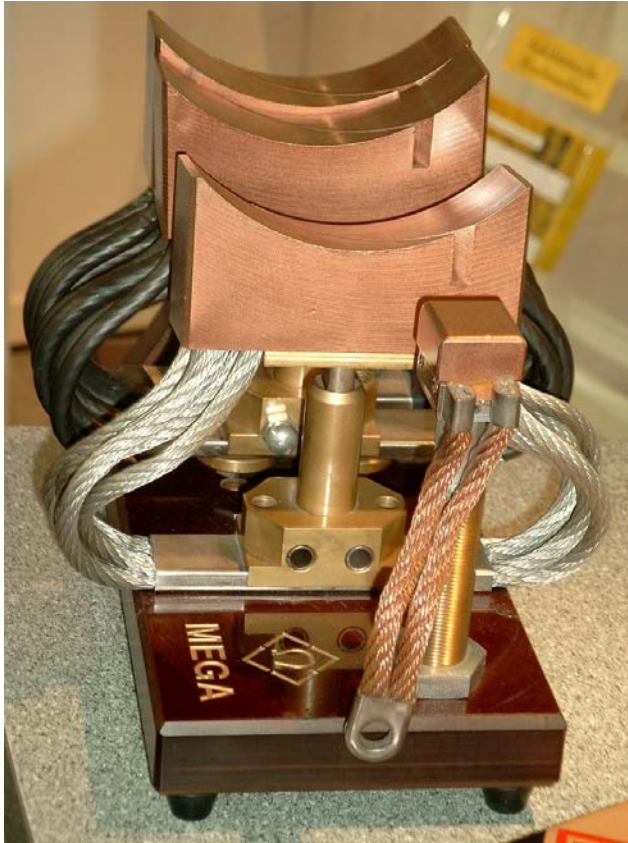
Figura 11: Las escobillas de grafito de un compuesto de cobre sinterizado son una alternativa a los cepillos de carbono puro
