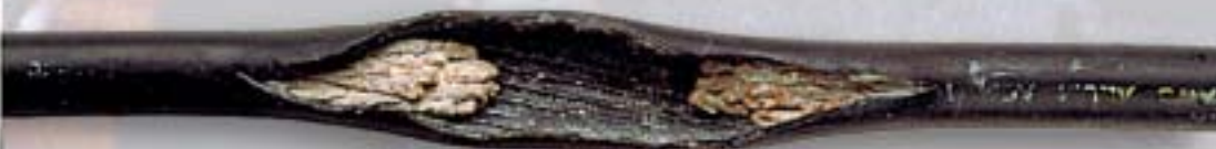
Cable de aluminio deteriorado por la corrosión
